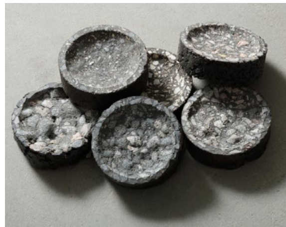
Bild. 1. Asfaltprover efter prall-test.
