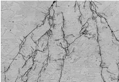
Kloridinducerad stress corrosion cracking är orsak till allvarliga problem i badhus.
