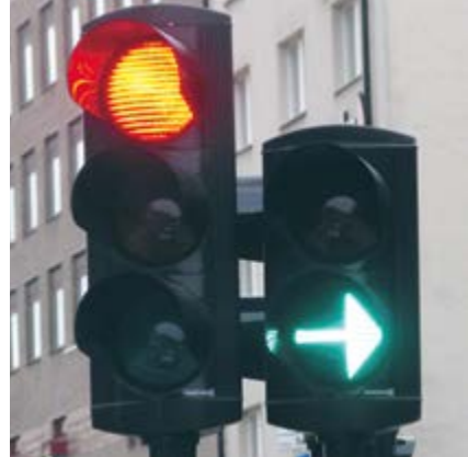
Bild 7. Med en undantagssignal (ytterligare två ljusöppningar) kan högersvängande trafik svänga höger trots att trafik rakt fram och vänster har rätt, 20 – 25 §§. Detta kan ge en effektiv styrning.
