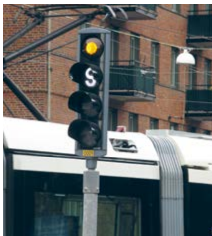
Bild 17. Indikeringslampan i en fjärde ljusöppning för att visa att buss/spårvagn är detekterad. Olyckligt att indikeringslampan i detta fall är gul eftersom fast gul signalbild betyder "stanna".
